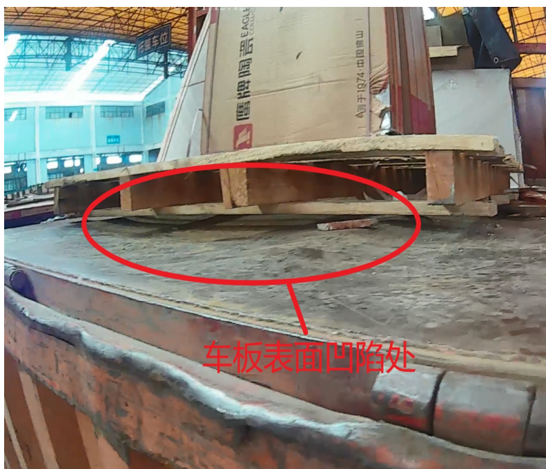
图 4 车板表面凹陷处
