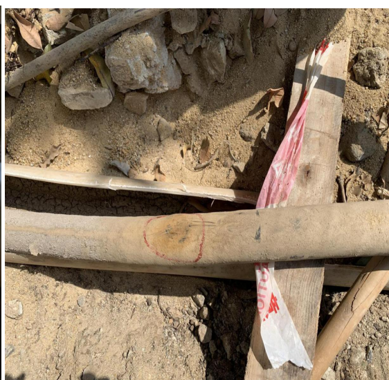
图9 1#点套管拆除后外护套灼伤图
