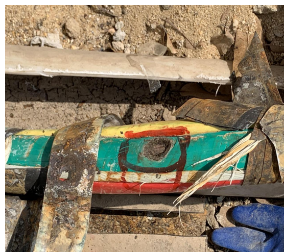
图 7 1#点铜导体绝缘层伤口图
