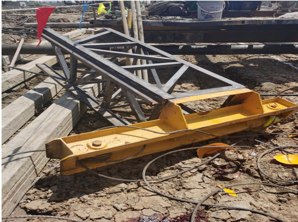
图三 断裂坠落的钻桅“标准节”及顶部型钢横梁
