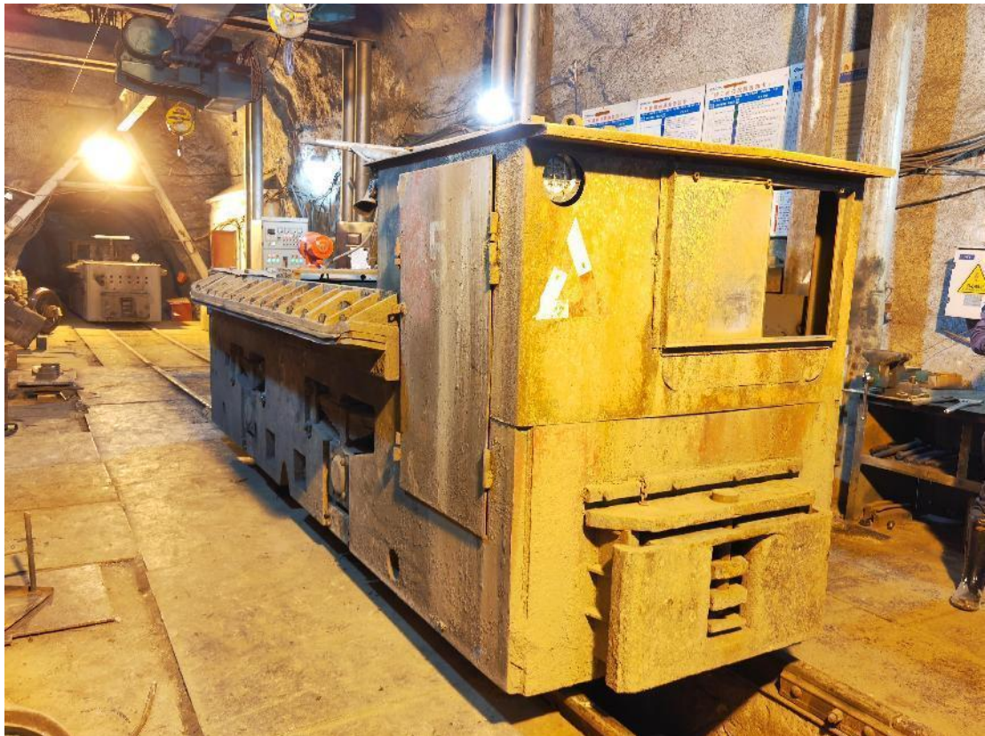
图 8 CJY14/7G 型电机车
