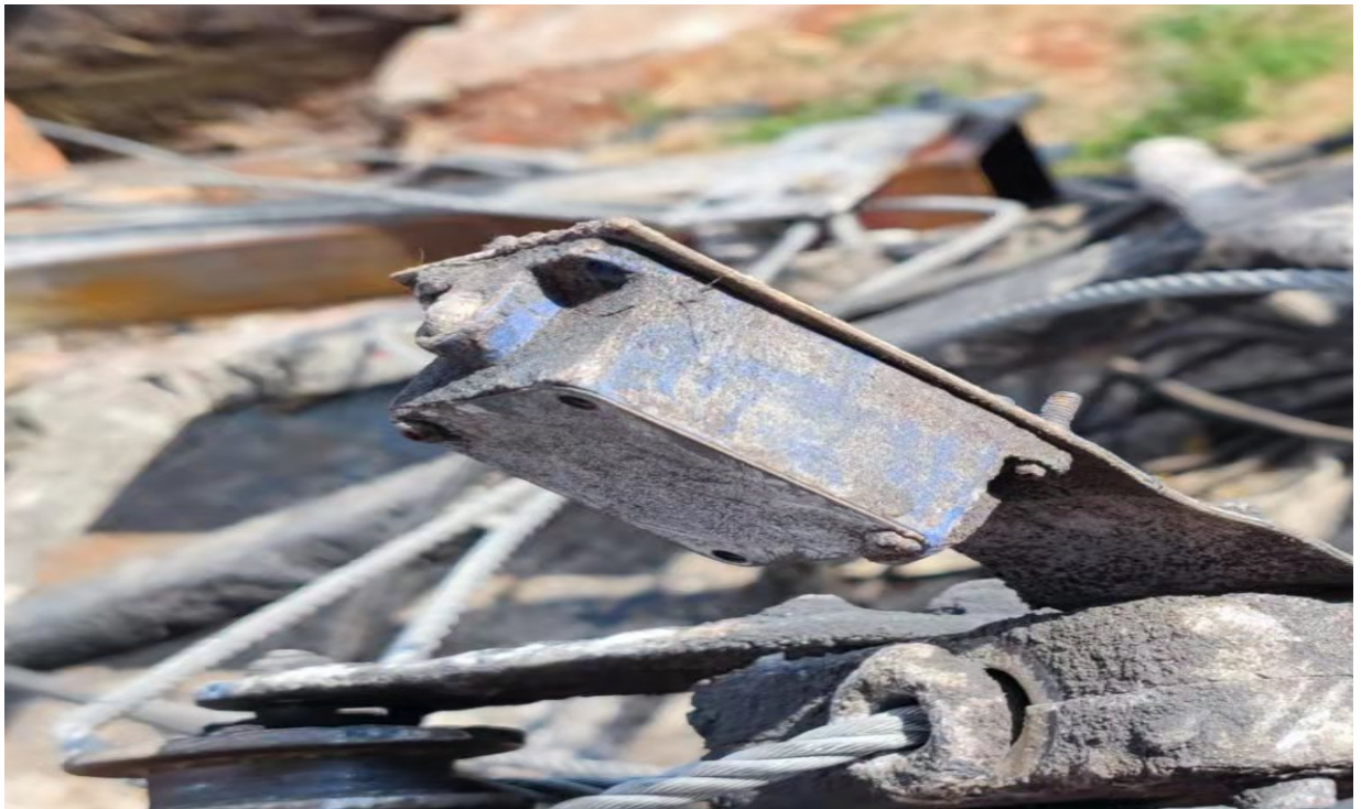
图 11:2 号吊篮右端悬挂机构前梁比左端悬挂机构前梁长 200mm
