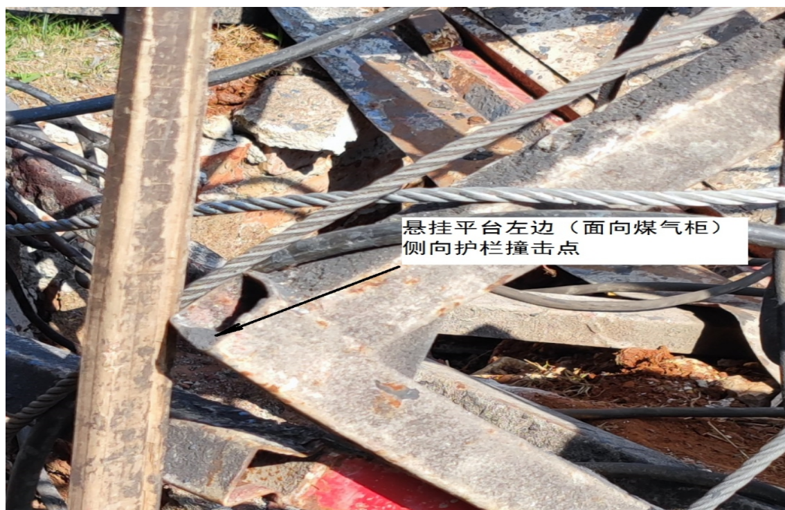
图 5：2 号吊篮悬吊平台左边（面向煤气柜）侧向护栏与煤气柜屋面挑檐底部撞击点
