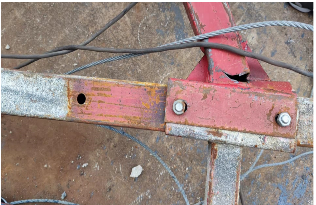
图 11:2 号吊篮右端悬挂机构前梁比左端悬挂机构前梁长 200mm
