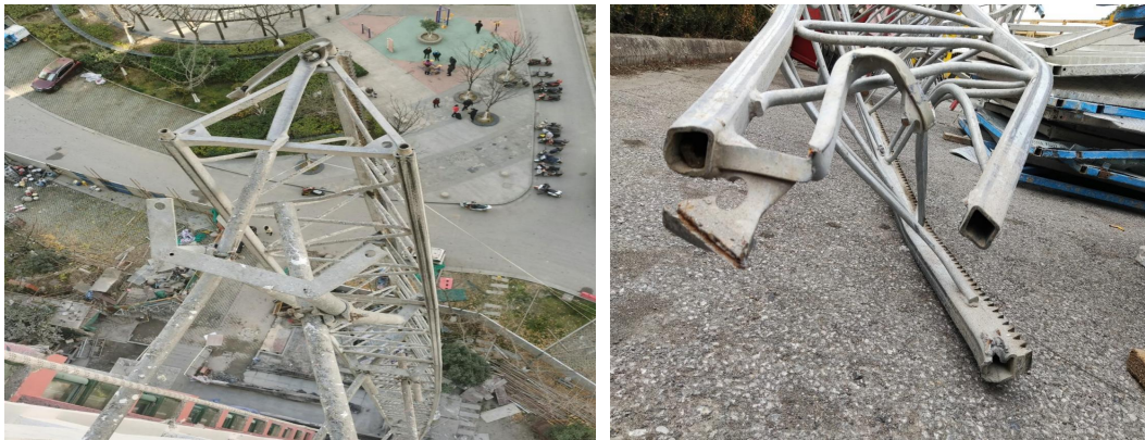
图7 东侧立柱第26节上端实景图 图8 东侧立柱第27节下端实景图（坠落段）
