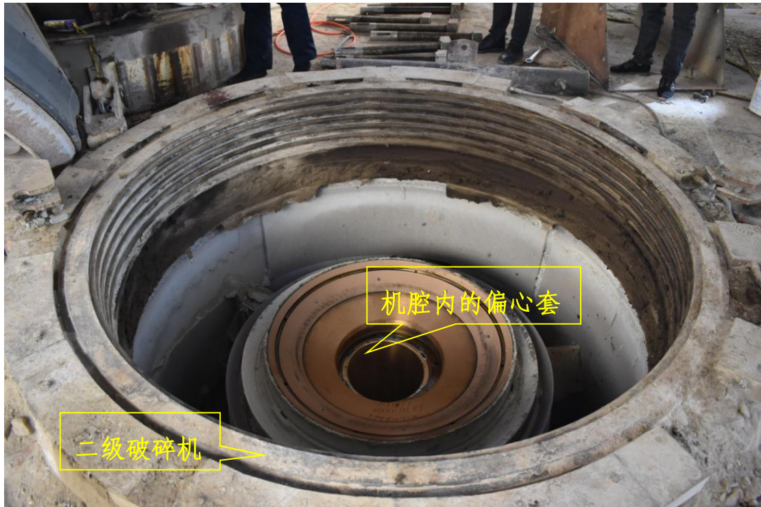
图 8 二级破碎机机腔及偏心套等结构
