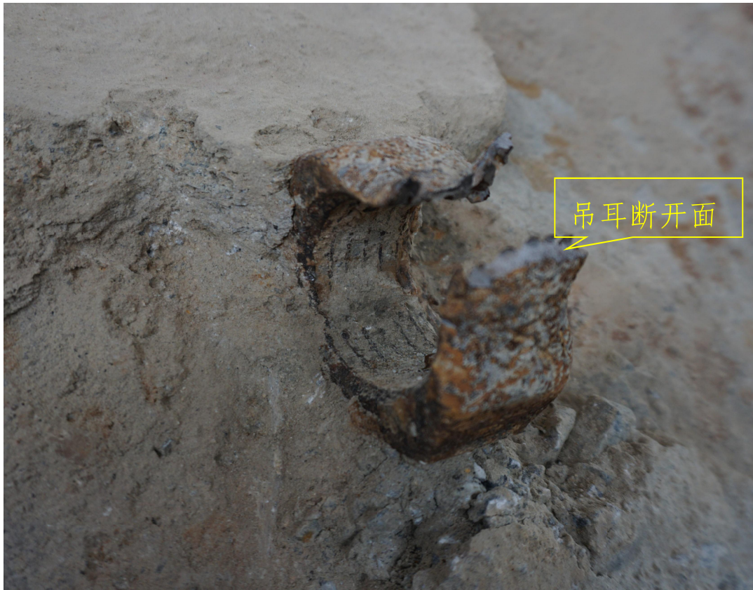
图 12 吊耳断开断面
