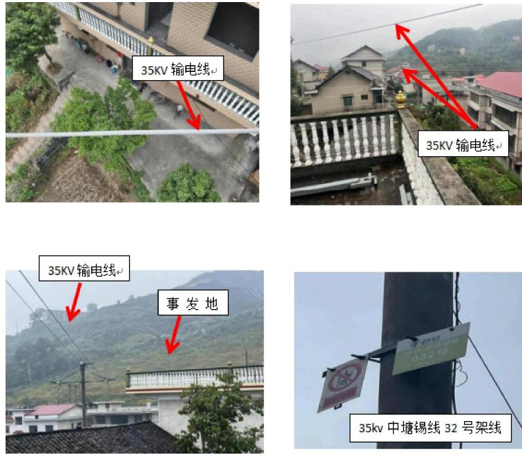
房屋东南角方向有35kV输电线路通过，线路名称：35kV中塘锡线，线路自220kV中连变电站送出，分别接入冷水江塘冲煤矿35kV变电站、锡矿山闪星锑业公司35kV变电站，属于一类用户供电线路。位于房屋东南角外侧的为35kV中塘锡线#032-#033杆段，杆段内导线对地面高度10.35m，导线对房屋天台水平距离2.6m，对房屋天台垂直距离3.1m，净空距离4.05m。
