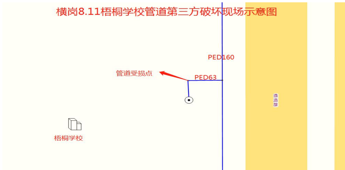
燃气泄漏管段走向图
