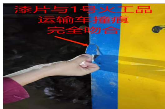
图8 漆片与1号火工品运输车的痕迹吻合
