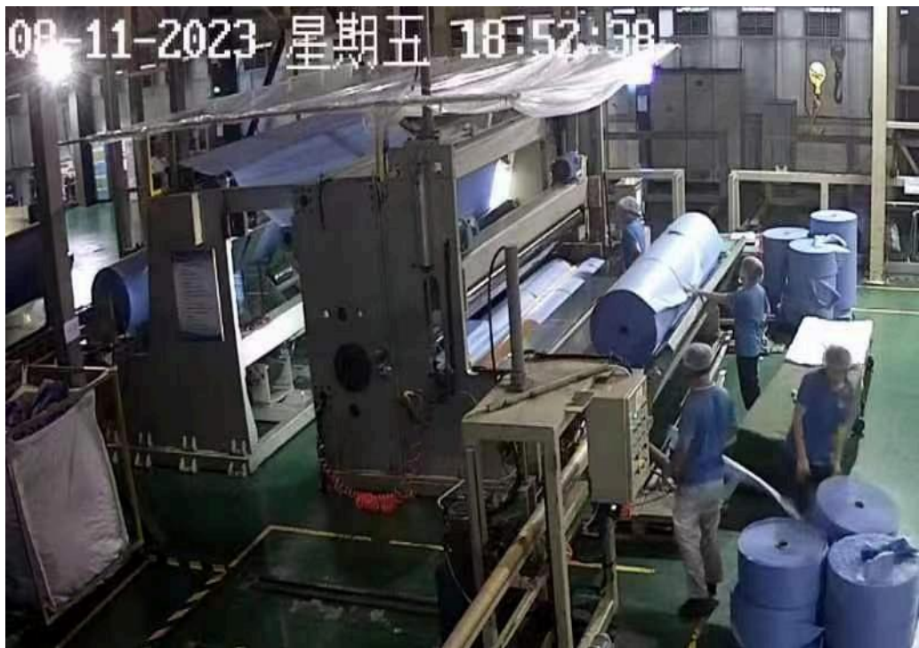
图2事故发生现场，黄某铁误操作后，接布架朝黄某铁转过来。
