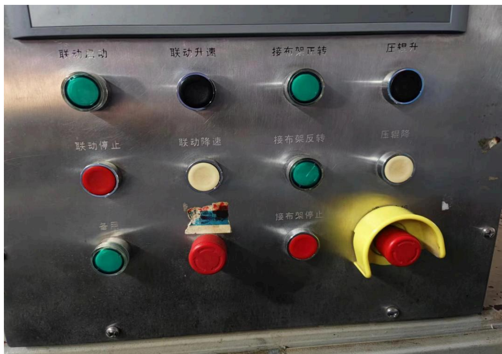
图4事故发生前的接布架控制面板。
