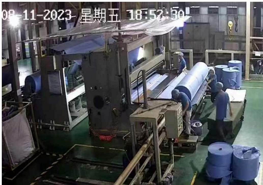
图1事故发生现场，黄某铁划布后，准备按接布架反转按钮。
