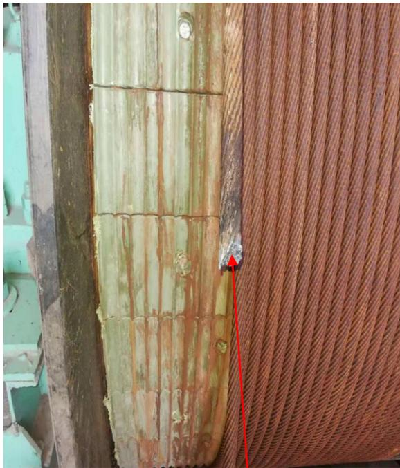
图 5 被气割切断的钢丝绳
