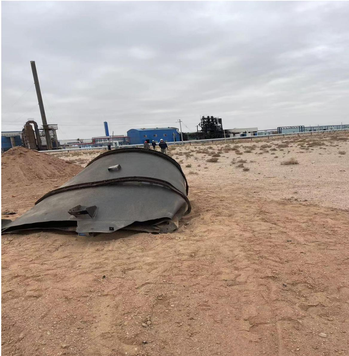
图3 一效分离器上部主体散落位置图
