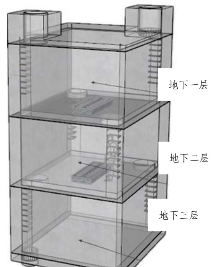
图 1 事发电力井立体示意图
