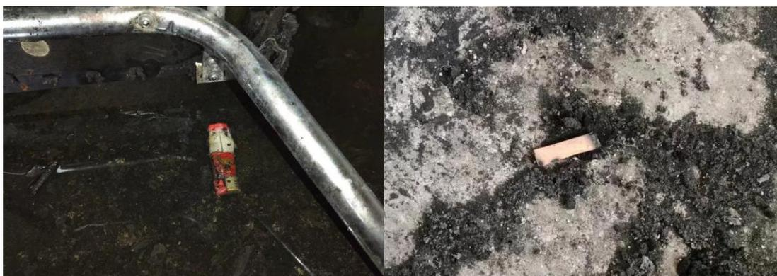
图 3.3、3.4 非法作业点地面表面微熔的打火机 局部炭化烟头
