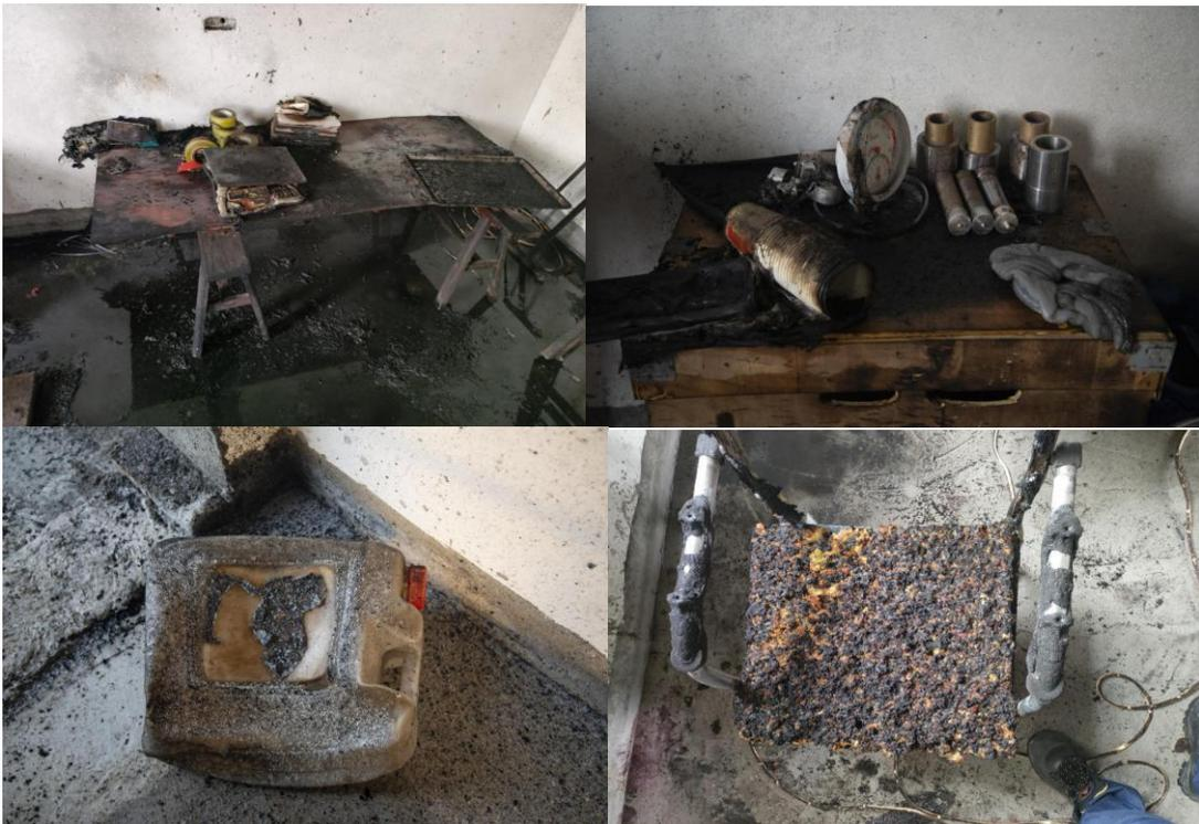
图 1.8-1.11 事故发生部位附近的木质桌子以及塑料制品等表面有掉落的炭化残留物
