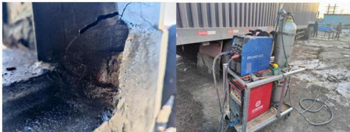
图 5：车箱左后焊接痕迹
