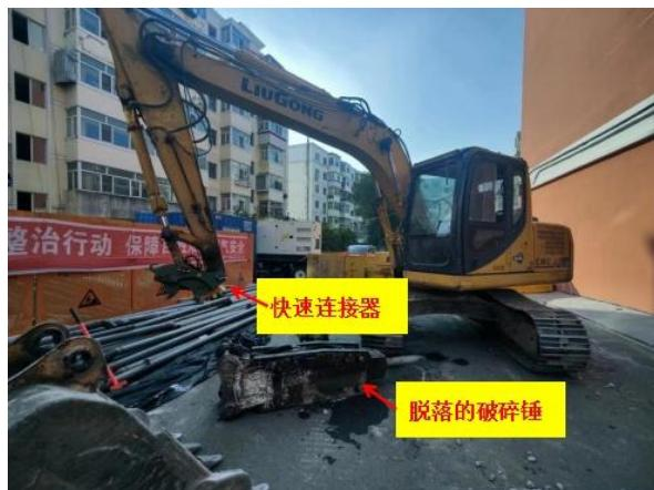
在快速连接器安装完成后，赵洪利登上挖掘机驾驶室，准备连接破碎锤，葛海刚绕到挖掘机后面清理手上的黄油，张天磊和赵江也先后离开挖掘机作业区域，随后赵江独自返回了挖掘机作业区域内的作业现场。赵洪利操作挖掘机支臂，将快速连接器连接到破碎锤上，在操作支臂起吊的时候，破碎锤从快速连接器脱落，砸倒了返回现场的工人赵江。
