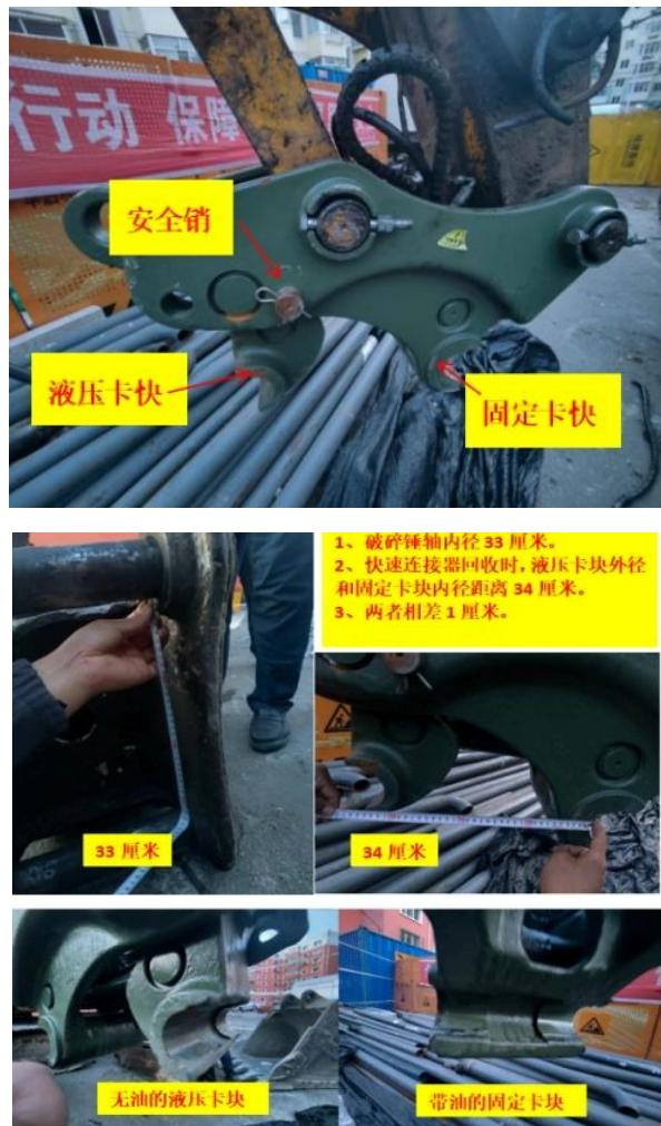
事故调查组组织专家对现场进行了技术鉴定，专家组出具了《技术鉴定报告》。经现场检测：快速连接器液压卡块回收时，液压卡块外径和固定卡块内径距离34厘米，与破碎锤两轴内径33相差1厘米，说明快速连接器卡槽不能顺利进入破碎锤两轴间。破碎锤两轴均有大量的黄油残留，如果连接器的两个卡块与破碎锤的两个轴安装到位，连接器的两个卡块与破碎锤的两个轴会充分接触，卡块内径会有黄油残留，经查，固定卡块内径黄油痕迹明显，液压卡块内径无黄油痕迹。
