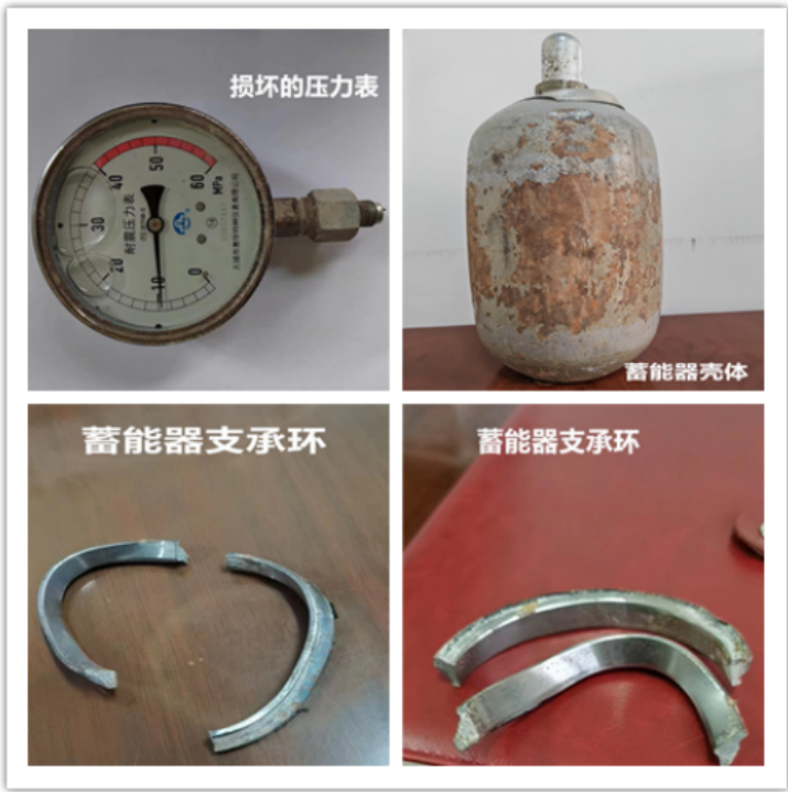
图5 事故现场采集的蓄能器及支承环
