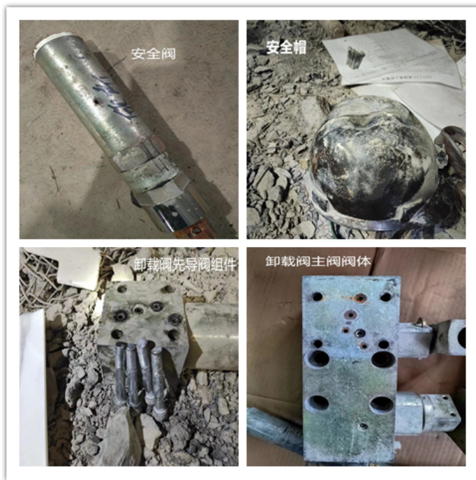
图3 事故现场部分损坏零部件
