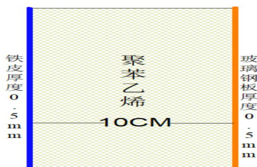
图 2 孟凡凯纸制品厂建筑墙体剖面示意图
