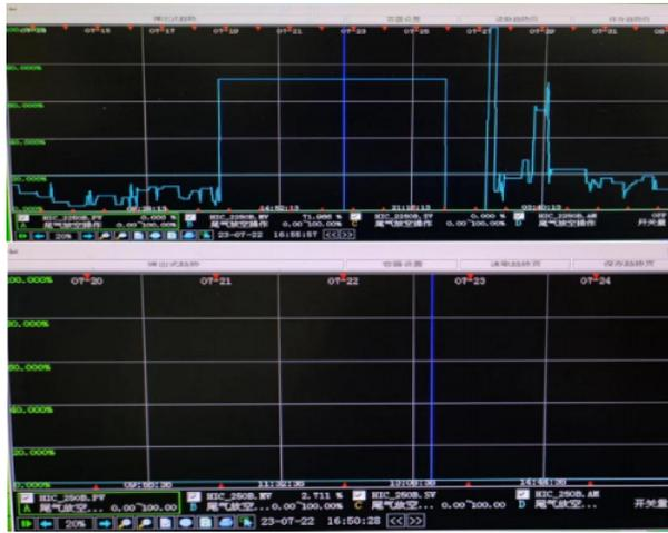
② 15点31分，C2301风机启动后，1号箱体差压、主袋入口压力上升时间为同一时间，而其他箱体差压基本无变化。说明C2301风机启动后，气体沿着1号箱体反吹阀门进入了箱体。
