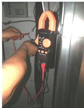
图7 应急电路电压测量（224V）
