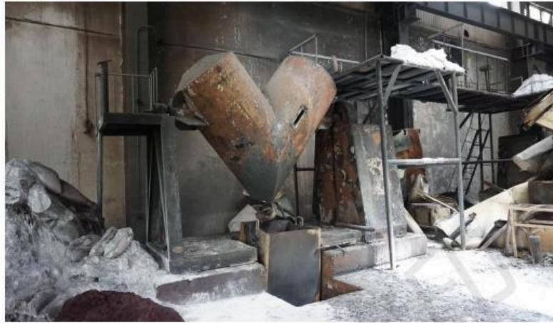
图 3：事故区域 V 字型混料机外貌
