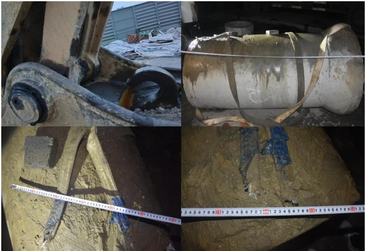
图 5. 事故挖掘机吊钩、吊带及吊装物
