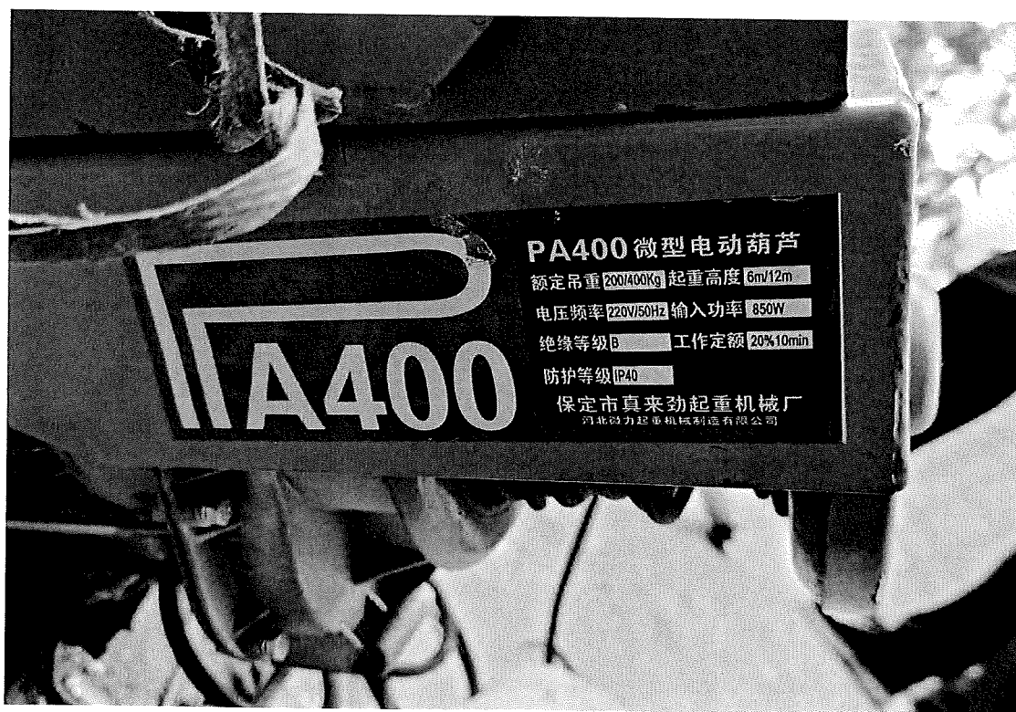
图 3 提升机所配电动葫芦
