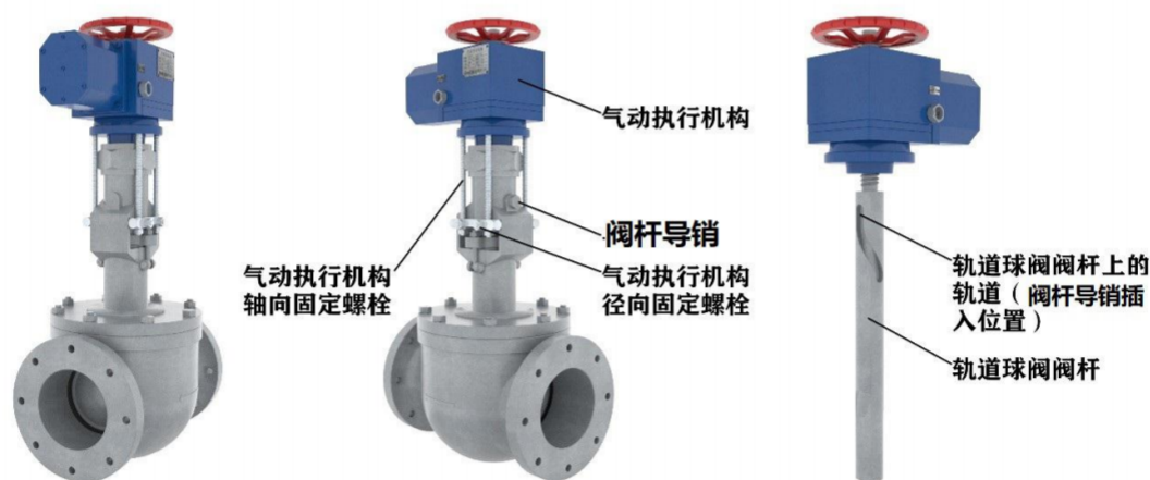
图 1-4 改造后轨道球阀三维示意图
