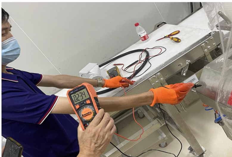
图13 电源线触碰外壳电压为234V
