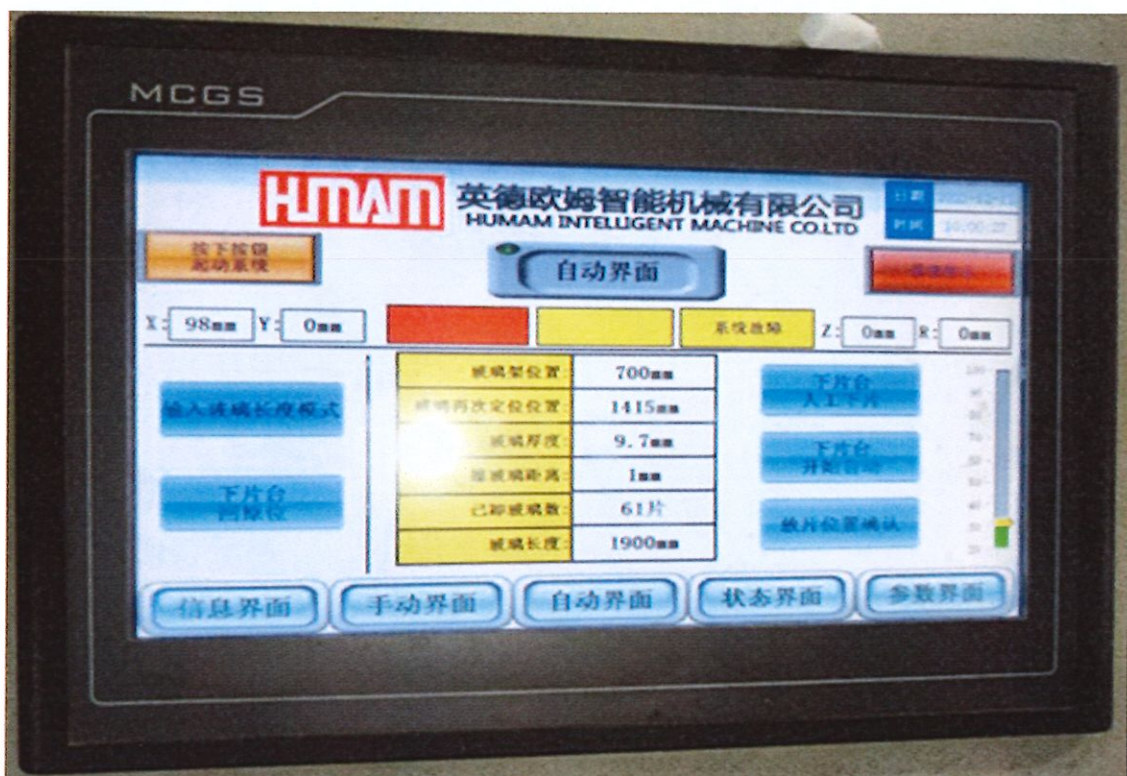
图4 涉事五号磨边线自动下片机控制柜显示屏
