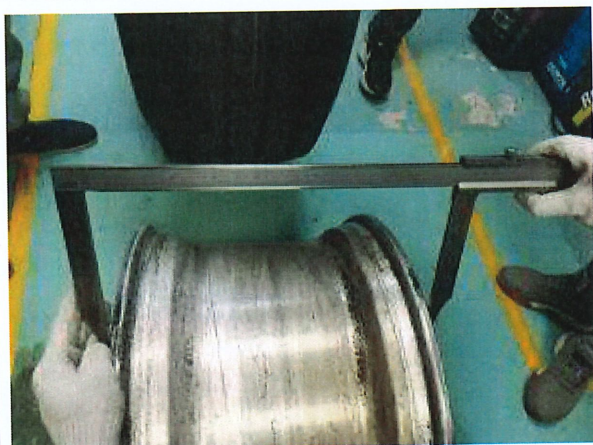
图 14 轮缘位置 1 圆跳动最大值 5.29mm
