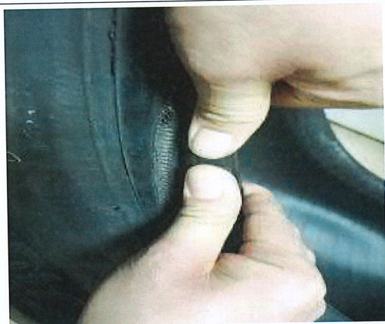
图 8 涉事轮胎端口中间深，两端浅
