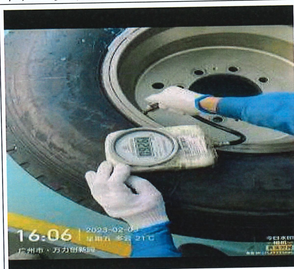
图 8 涉事轮胎端口中间深，两端浅
