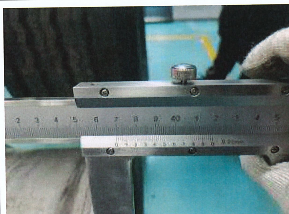
图 15 轮缘位置 2 圆跳动最大值 4.90mm
