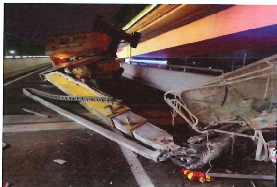
图2 侧翻的移动式升降工作平台
