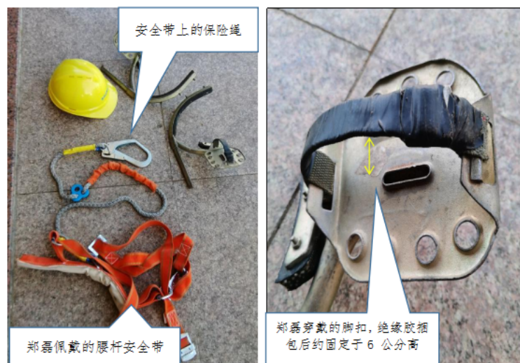
图5 郑磊高空作业时使用的安全带和脚扣
