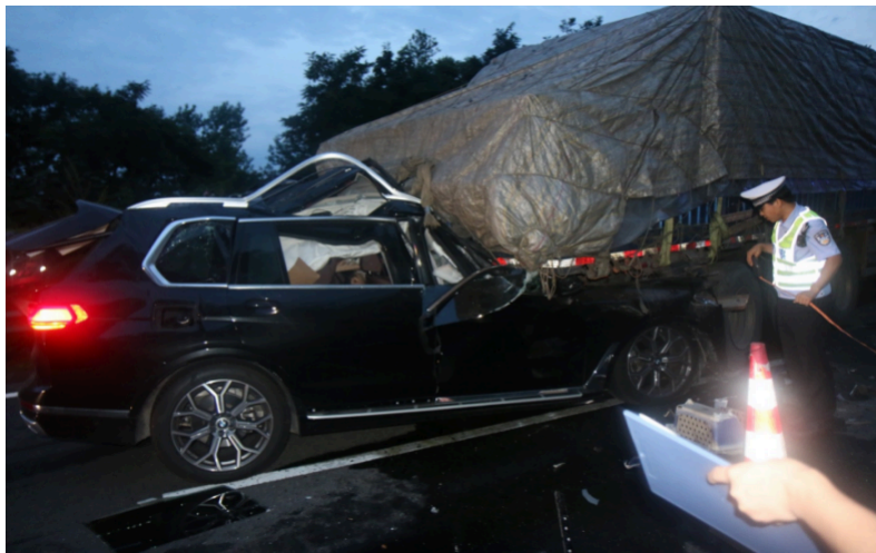
图4 皖SF8E93号小型越野客车前部卡嵌半挂车后部下方
