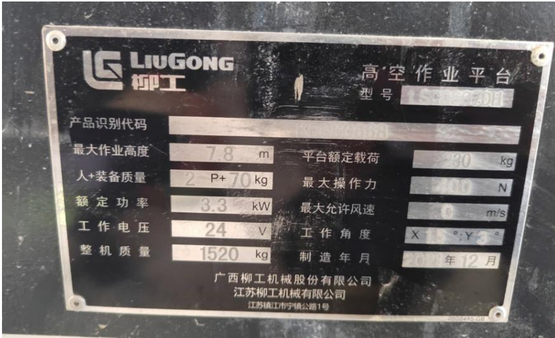
图4 涉事故高空作业平台铭牌
