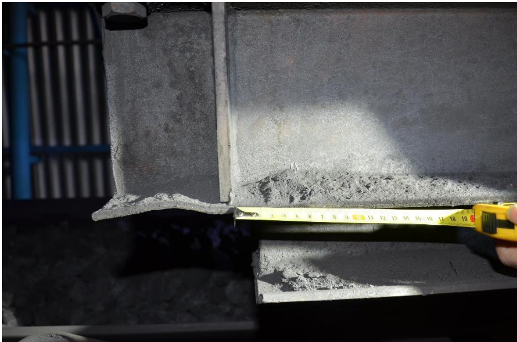
图 7 新 2 皮带除铁器边缘处手套印减层痕迹
