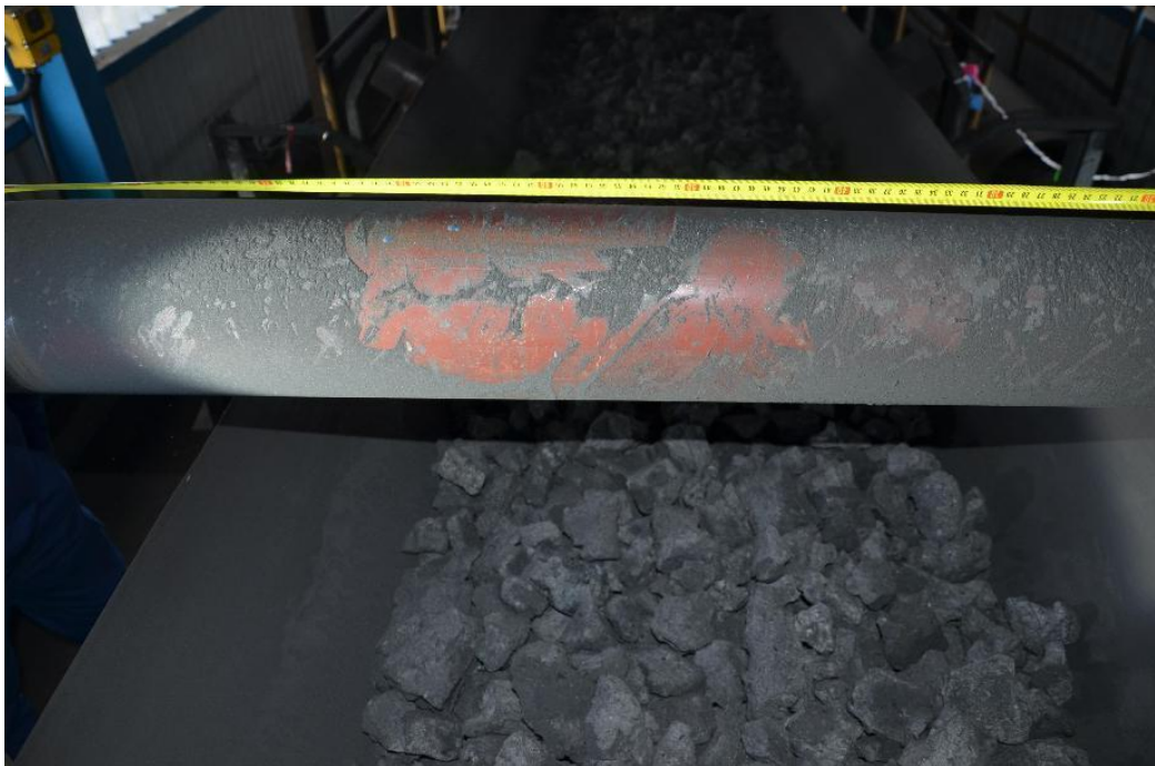
图 4 压带轮（编号 1310）滚筒中间部位摩擦减层痕迹
