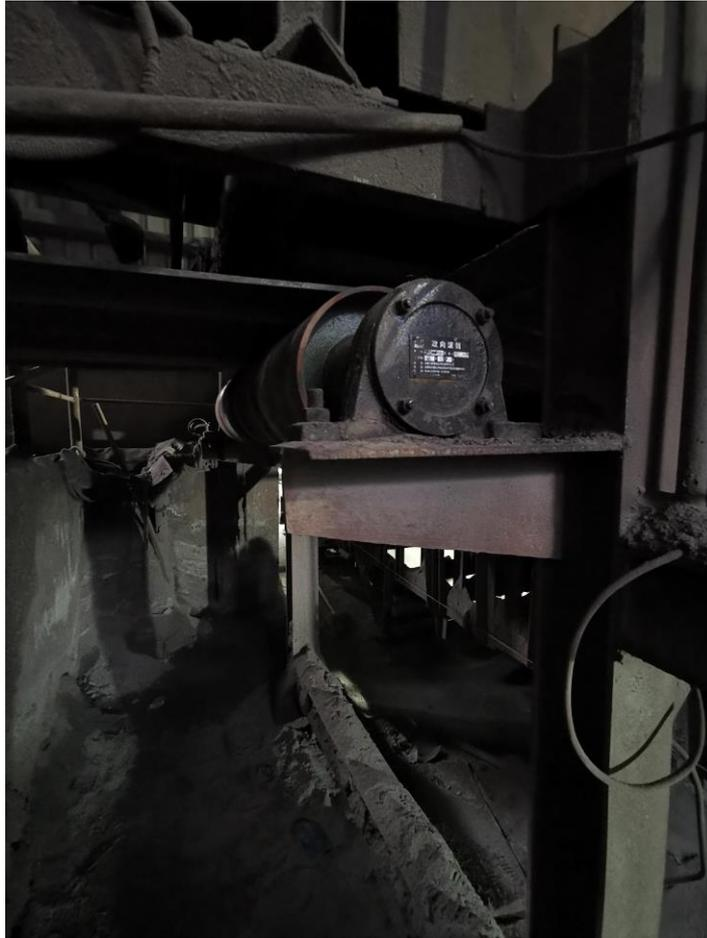
图六 6#配料皮带机头轮下方的增面轮
