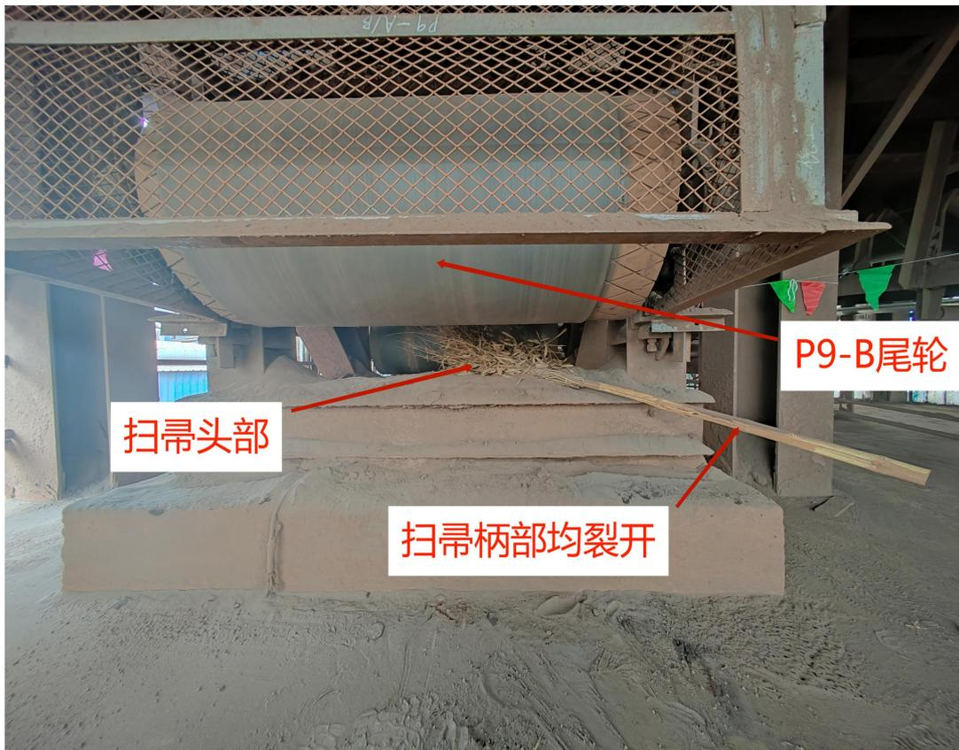
图三：P9-B 皮带机尾轮处
