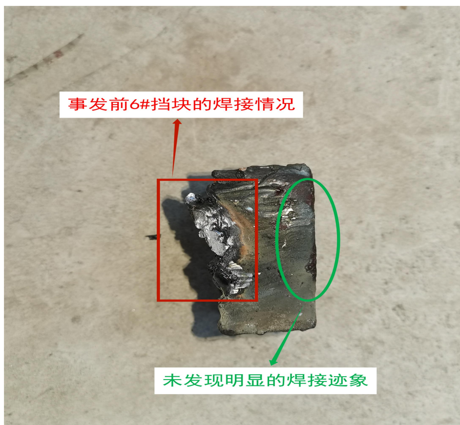
图十二：断裂的 6#台车挡块焊接情况
