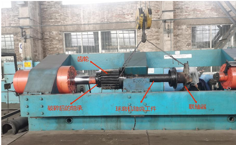
图 1：球磨机轴齿工件示意图
