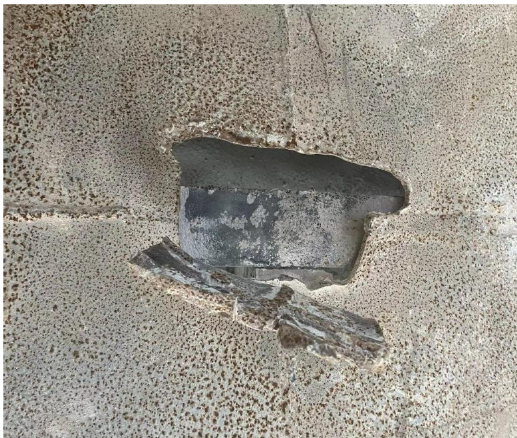
图 24 事故 D 灰斗第七层节点内部焊缝相交处破坏情况
