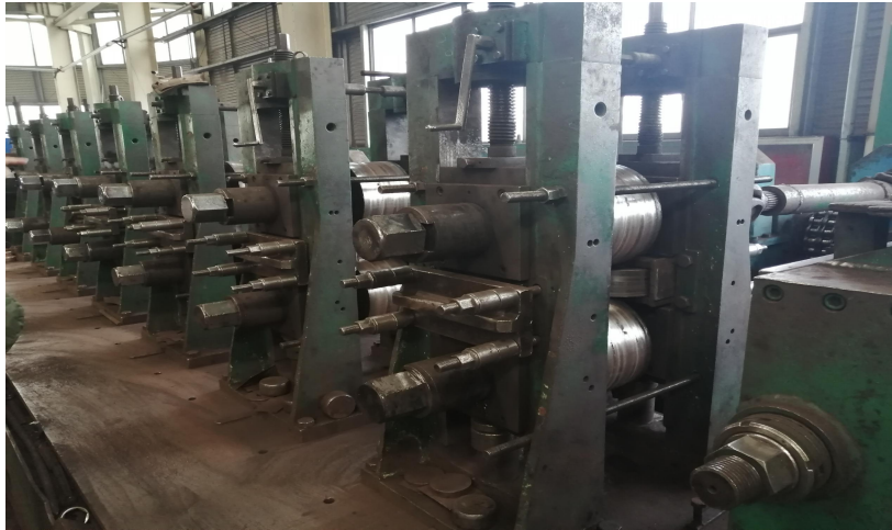
万信公司的冷拔改拔生产线，无热处理工序
