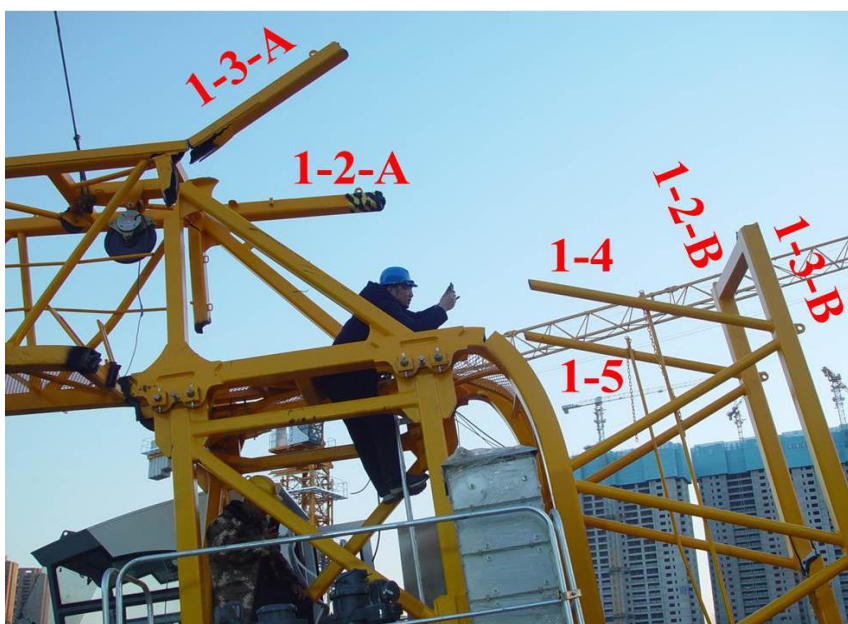
起重臂第一节上弦杆断裂部位及编号
