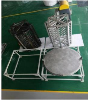
图2: 钛粉脱氢热处理炉托盘
