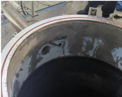
图3: 钛粉脱氢热处理炉顶部与真空泵连接的管道
