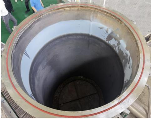
图1: 钛粉脱氢热处理炉炉内
