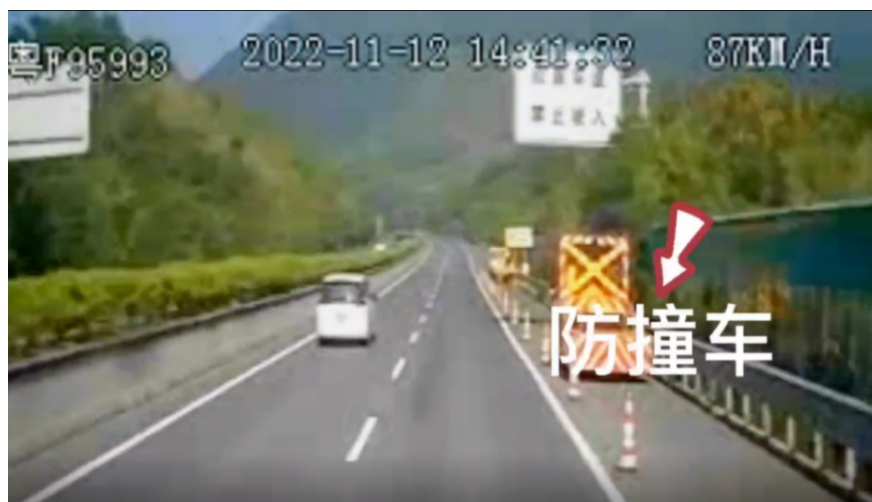
图 6 防撞警示车位置（位于应急车道内）
