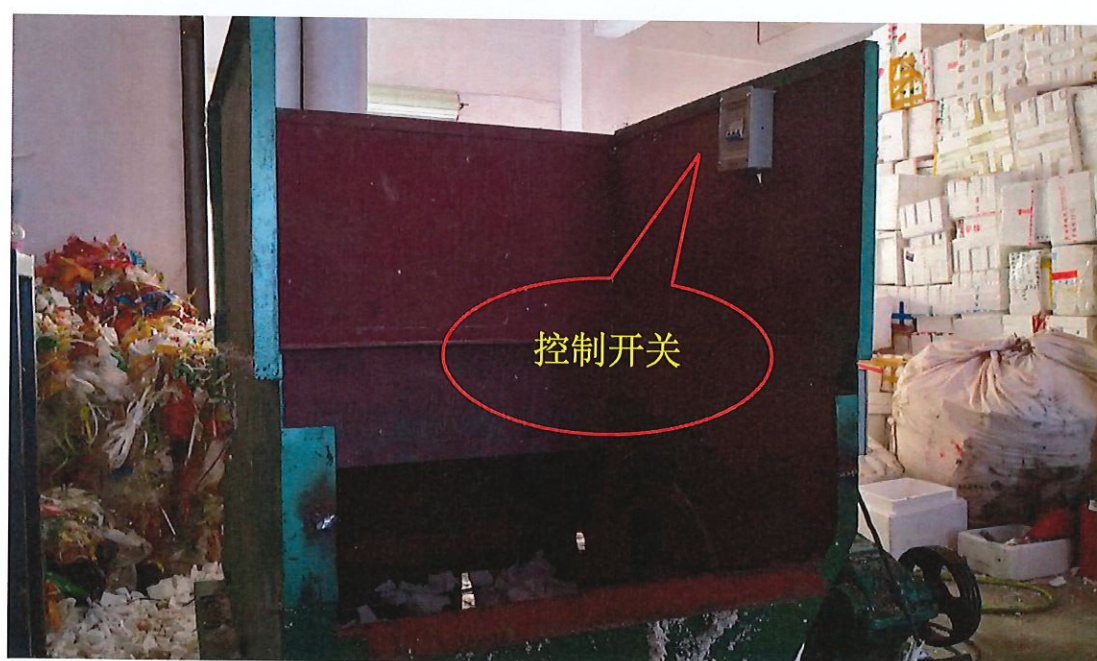
图 6 设置在碎料缸右侧上部的控制开关
