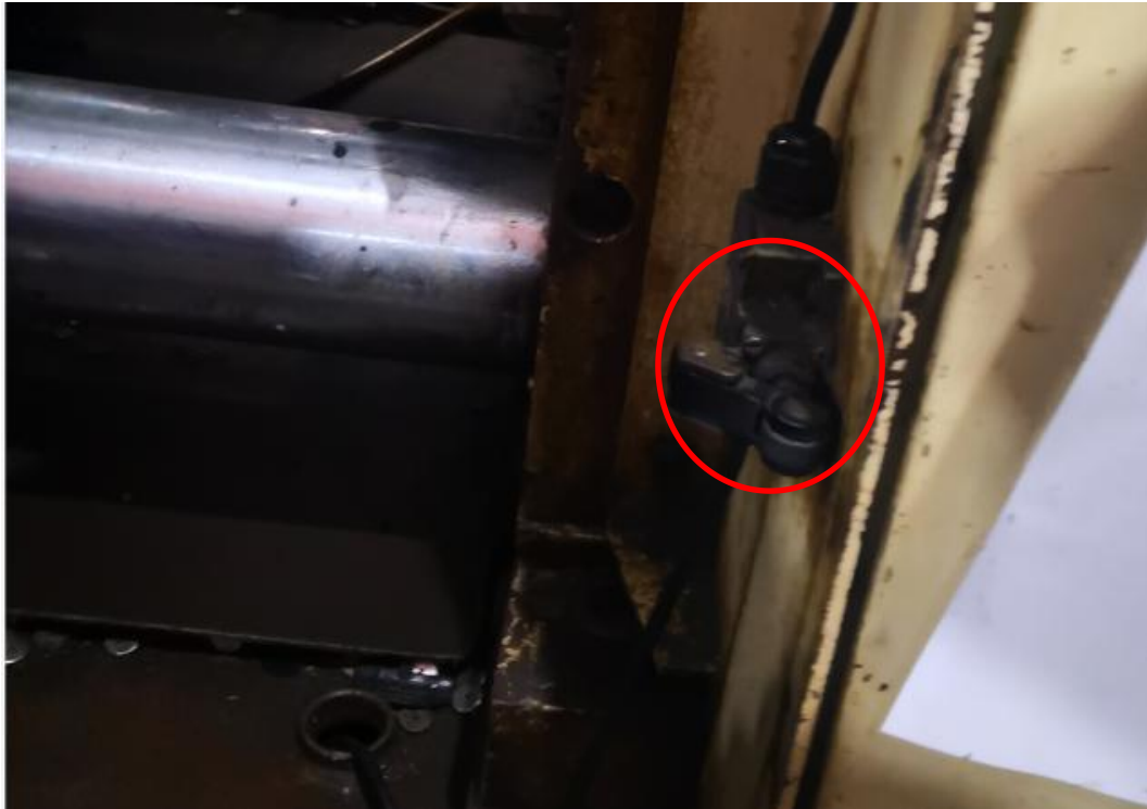
图 12 注塑机电器保险制动装置
