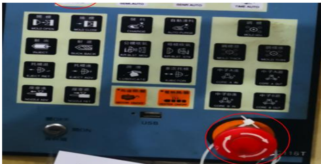
图4 注塑机控制面板上的急停开关
