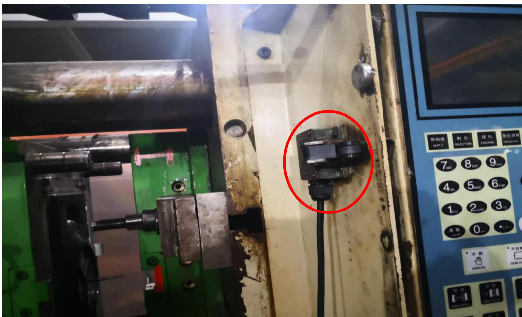
图 11 注塑机液压保险制动装置
