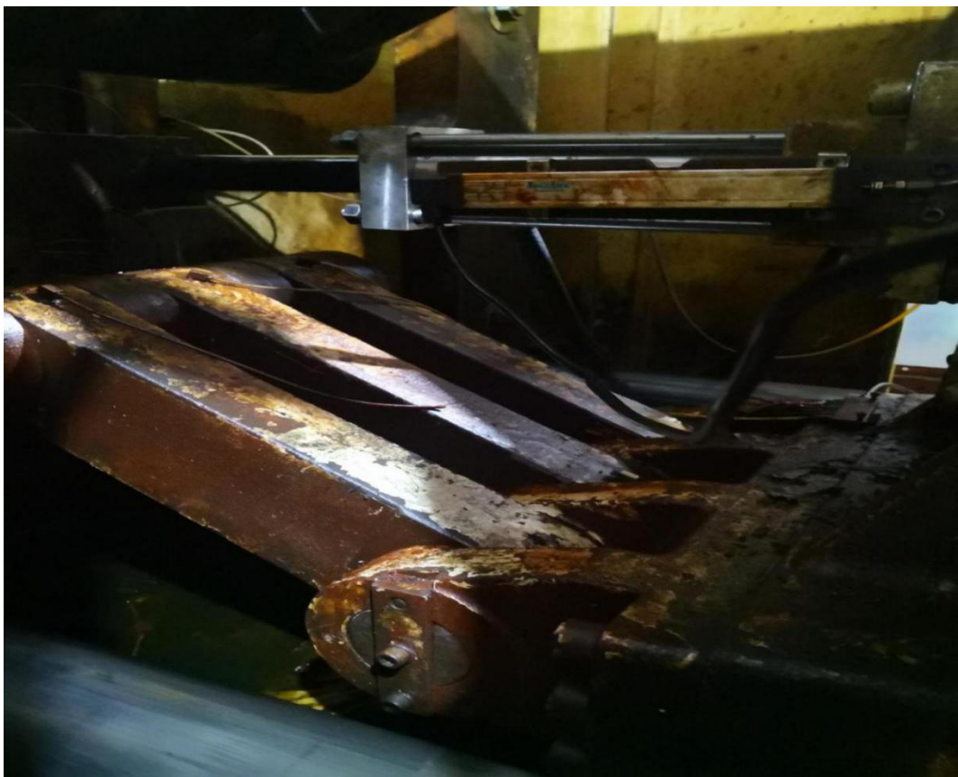
图 9 涉事注塑机的机绞装置
