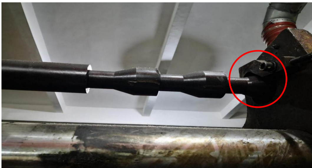
图 10 注塑机机械保险制动装置
