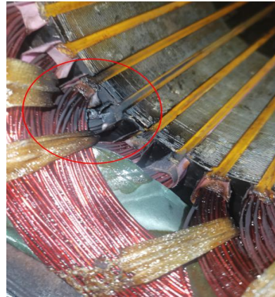
图 6-2 泵体上端接线正确图 6-3 泵定子线圈有烧蚀现象
