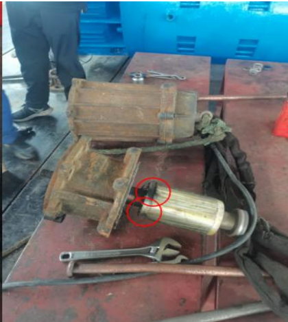
图 6-4 转子有烧蚀痕迹
