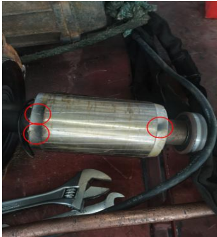
图 6-4 转子有烧蚀痕迹
