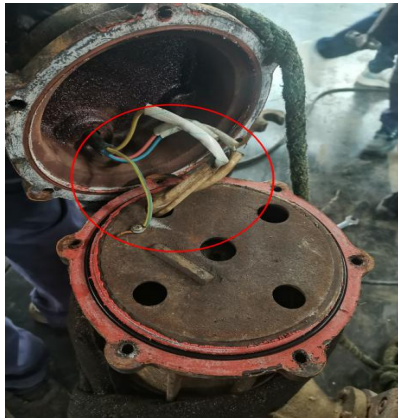
图 6-2 泵体上端接线正确图 6-3 泵定子线圈有烧蚀现象
