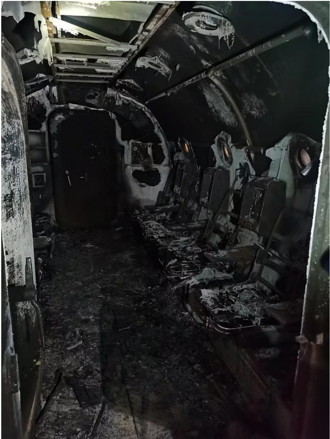
附图三 高压氧舱内部烧损情况
