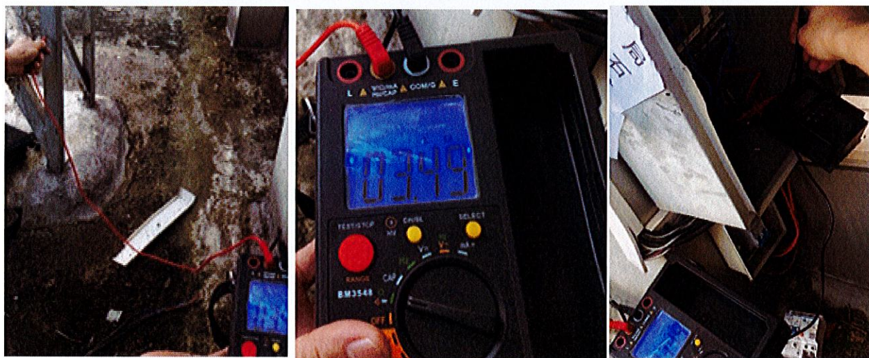
图 9 广告灯电气线路的绝缘安全性能情况
