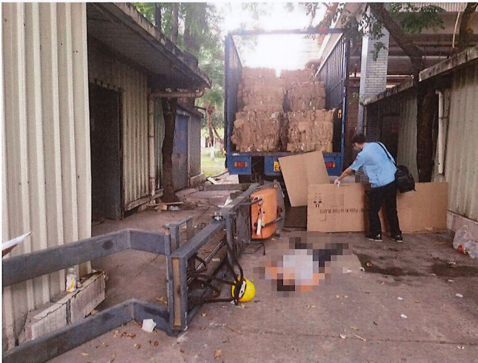
（图 1：事故现场涉事叉车倒地状态）
