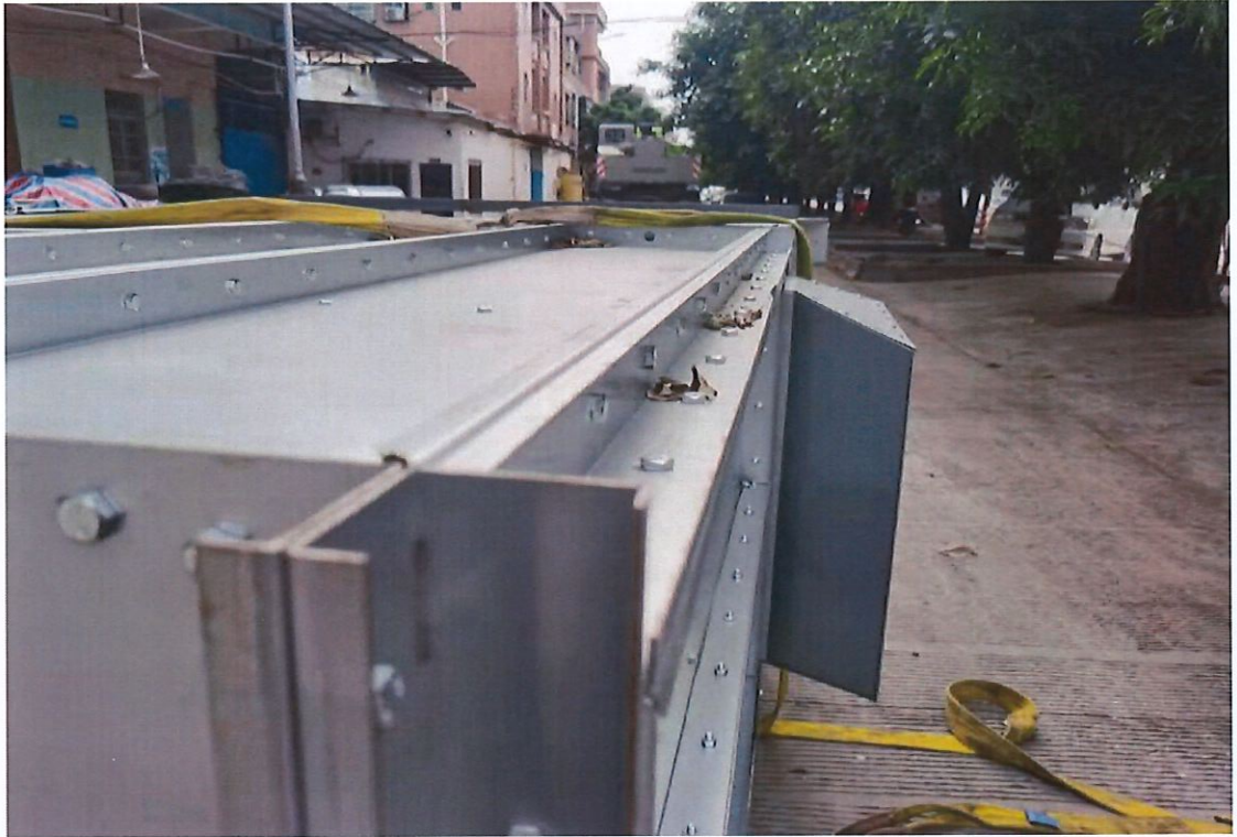
图 6：吊物棱角约为 15 毫米宽的钢铁构造
