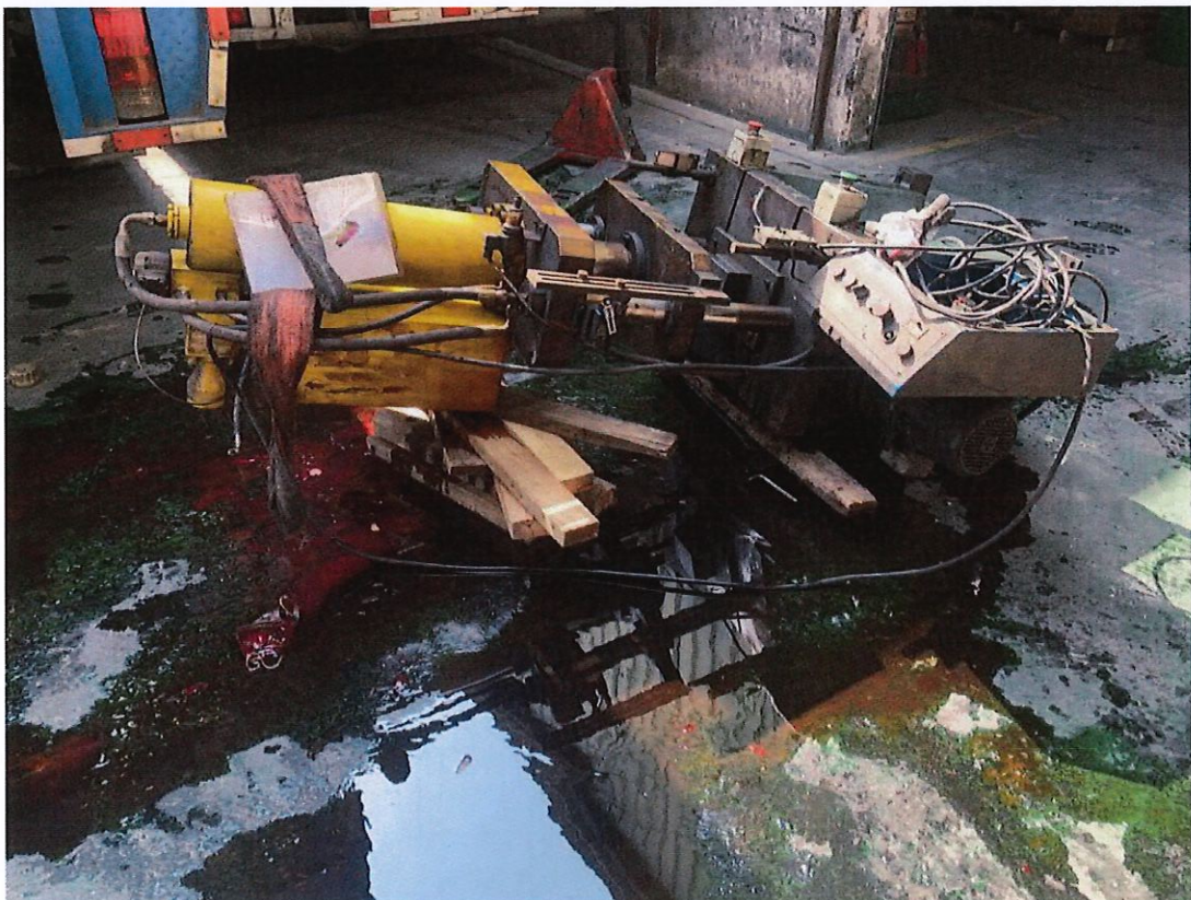
(图 3: 事故现场涉事液压机倒地状态)
