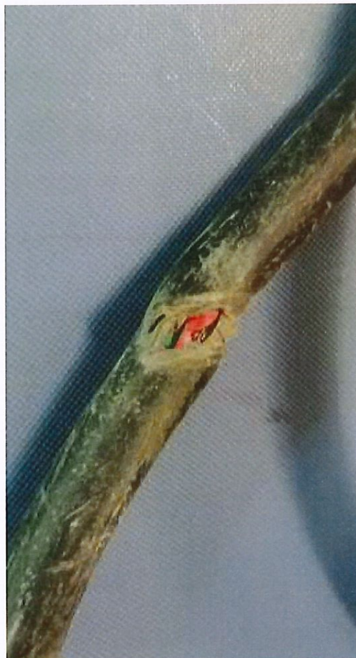
图 3 电缆接驳处导线绝缘层破损
