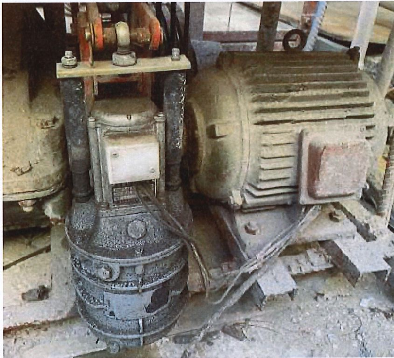
图 9 卷扬机电机导线未穿管保护
